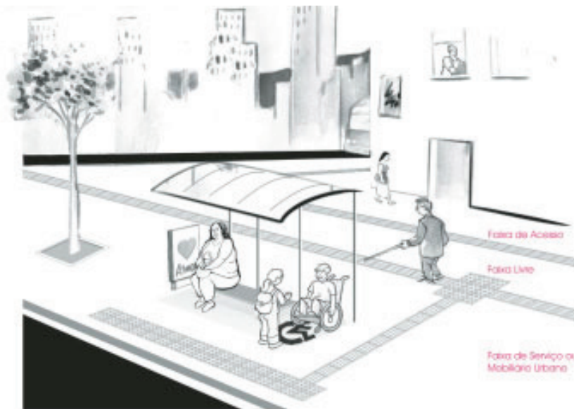
Figura 37 - Sinalização Tátil de Abrigo de Ônibus (Perspectiva)
