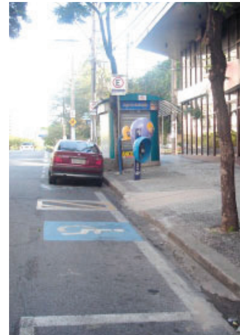
Foto 29 - Vaga Reservada de Estacionamento devidamente sinalizada e com rampa de acesso à calçada.
