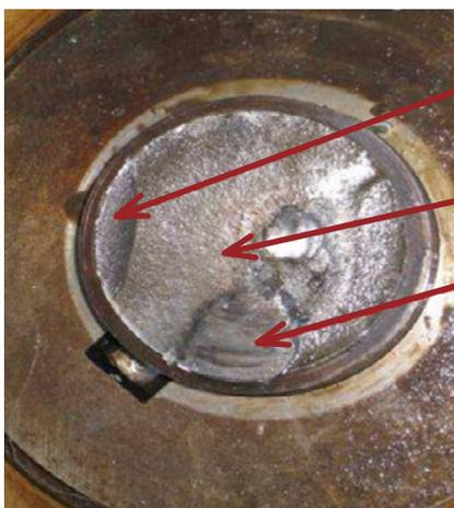
Local de início da trinca (superfície lisa). Sinais de corrosão.
