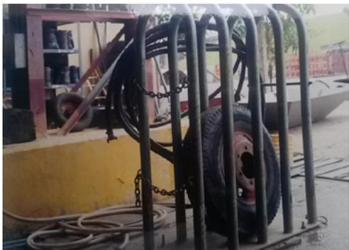
“Gaiola” de proteção para operação de enchimento de pneus de grande porte.
