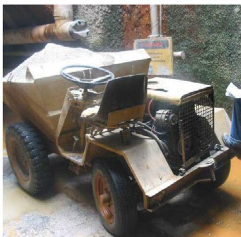
Máquina sem proteção para o operador.
